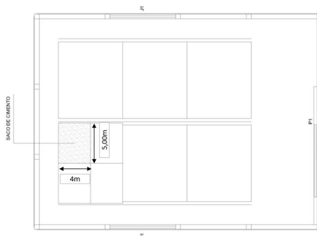
Layout de referência de depósito de canteiro de obra, em chapa de madeira compensada, utilizado para fins de especificação.
